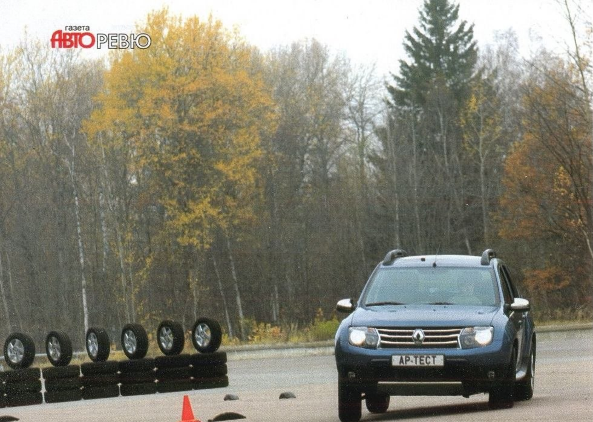
На некоторых шинах при выполнении «лосинового теста» водителю приходится корректировать занос быстрым рулением на большие углы
