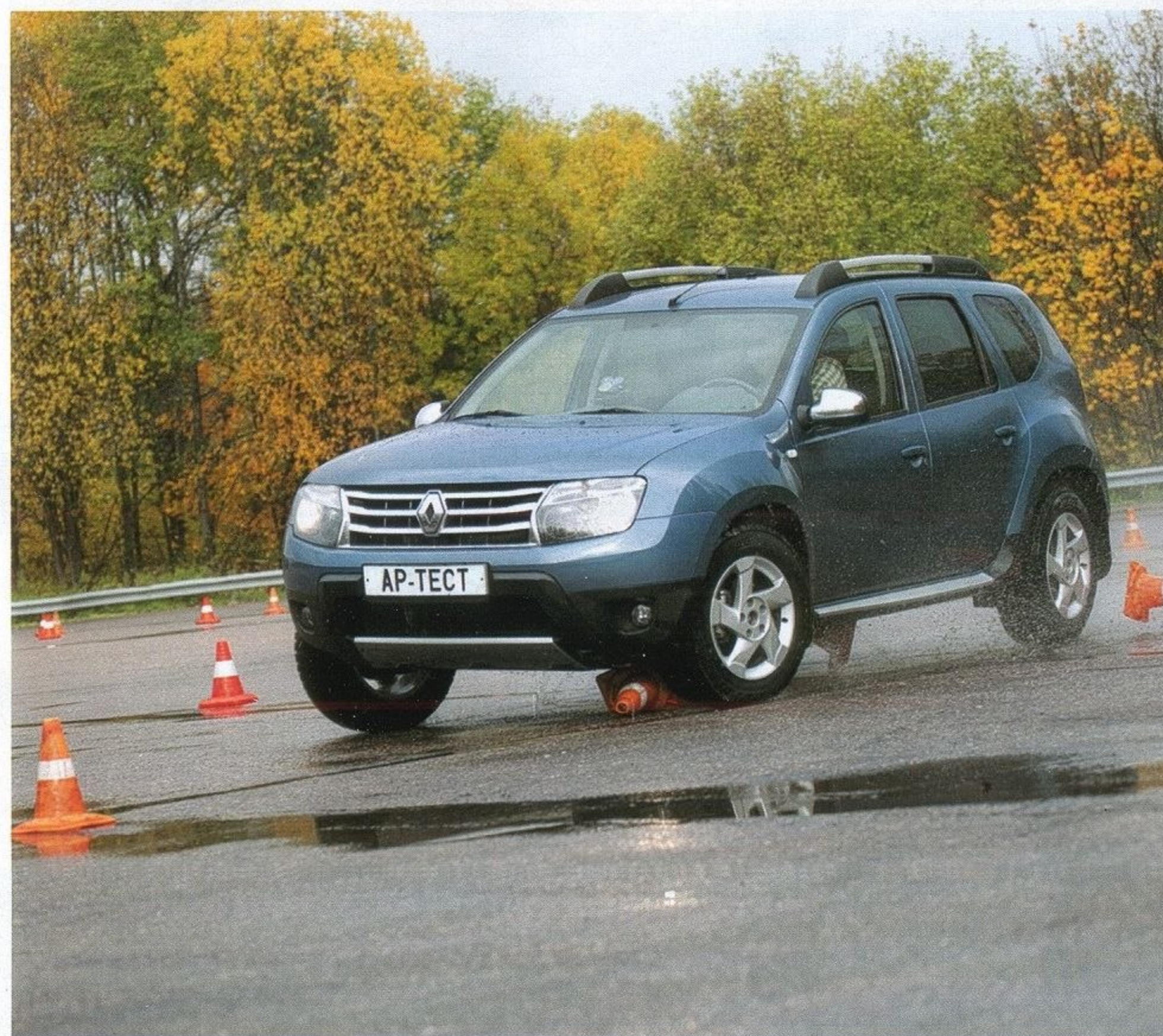
Скорость на входе в поворот превышена и автомобиль скользит, сшибает конуса. Но стоит заменить шины — и Duster легко вписывается в поворот на той же скорости
