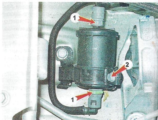
5. Устанавливаем новый топливный фильтр в кронштейн в соответствии с направлением движения топлива, указанным стрелкой на его корпусе. Подсоединяем к фильтру топливопроводы.
