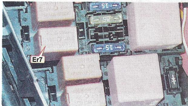
3. Устанавливаем реле на место.
