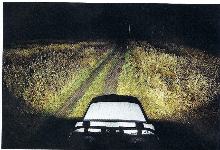
Две фары рассеянного света с максимально широким лучом (здесь 20 Вт/90°) оптимальны по углам багажника. Их можно даже еще развернуть в стороны, а между ними добавить пару прожекторов или балку
