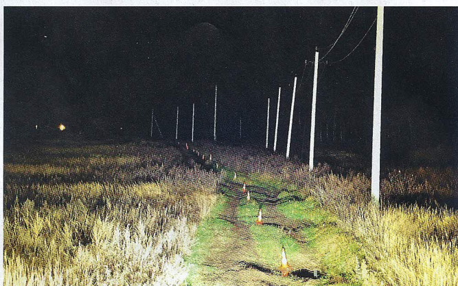
Мощные балки (234 Вт/30) при установке на бампере (фото слева) дают слишком яркую засветку вблизи и оставляют много темных провалов вдали. При установке сверху (фото справа) свет получается гораздо ровнее. При такой освещенности контраст капота и окружающей местности невелик
