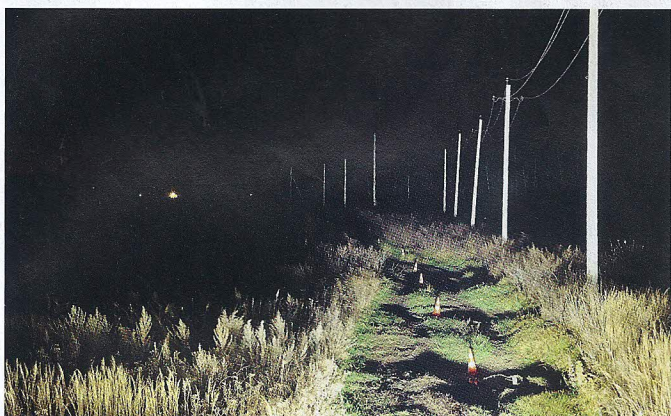
Мощные балки (234 Вт/30) при установке на бампере (фото слева) дают слишком яркую засветку вблизи и оставляют много темных провалов вдали. При установке сверху (фото справа) свет получается гораздо ровнее. При такой освещенности контраст капота и окружающей местности невелик
