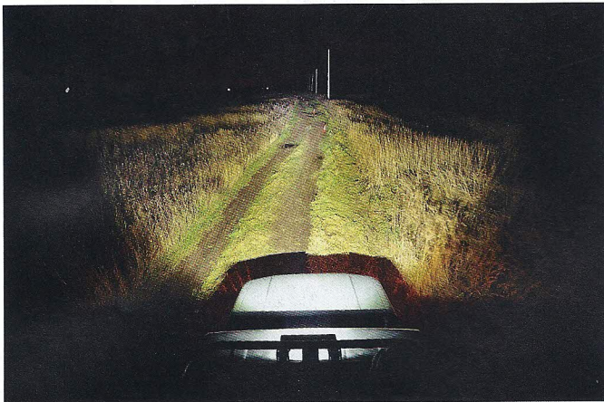
Мощность и размер имеют значение. Сравните: слева 30 Вт/8, справа 120 Вт/8. В лучах более слабой лампы даже видны красноватые блики от габаритных огней автомобиля. На правой фотографии габариты тоже включены, но на общий уровень освещенности в этом случае они уже не влияют
