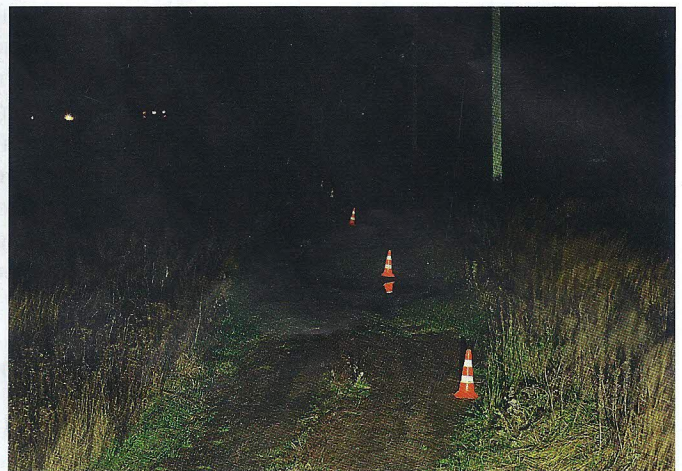
Оптический парадокс: с водительского места кажется, что пара 12-ваттных направленных фар (вверху) светит хуже, чем пара 10-ваттных рассеянных (внизу). Дело в освещенности ближнего плана, притом что направленные светят объективно дальше (справа)
