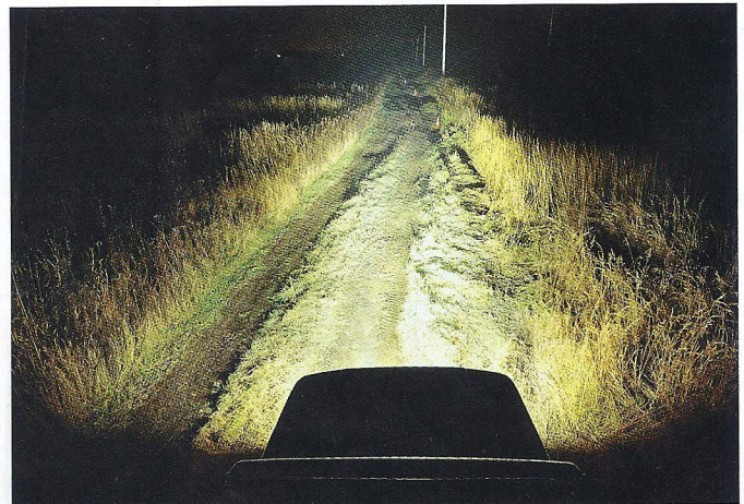
Одна короткая балка в качестве дополнительного дальнего света (слева) менее эффективна, чем два традиционных прожектора (справа)
