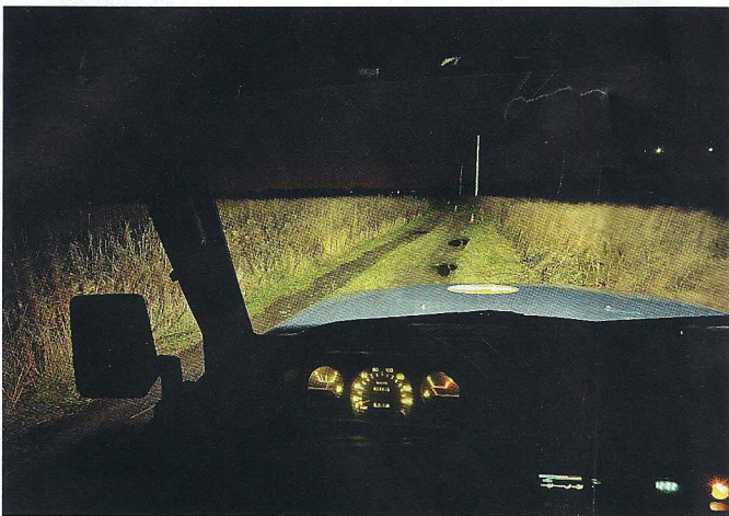
Оптический парадокс: с водительского места кажется, что пара 12-ваттных направленных фар (вверху) светит хуже, чем пара 10-ваттных рассеянных (внизу). Дело в освещенности ближнего плана, притом что направленные светят объективно дальше (справа)
