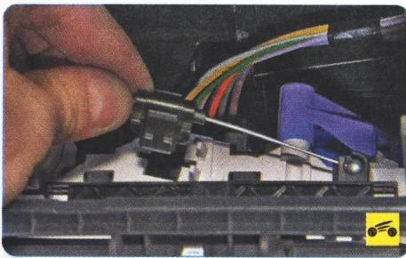
7. Сожмите фиксаторы и отсоедините от держателя 4 (рис. 12.7) блока наконечник оболочки троса привода заслонки рециркуляции.
