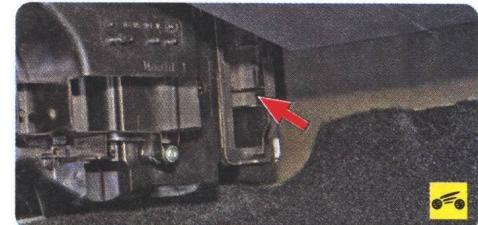
Фильтр поступающего в салон воздуха установлен под панелью приборов со стороны переднего пассажира, в закрытом крышкой отсеке климатического блока.
