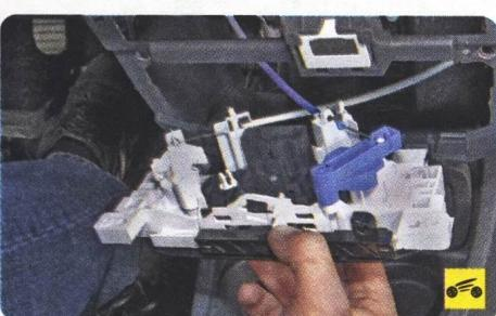
10. Выньте блок управления из гнезда в панели приборов.
