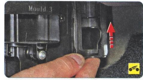
1. Для снятия фильтра нажмите вверх фиксатор крышки отсека фильтра.
