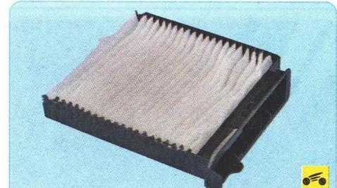
4. Установите новый фильтрующий элемент в отсек в порядке, обратном снятию, в том же положении, что и старый.
