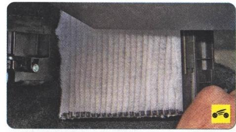
3. ...и выньте фильтрующий элемент из отсека.
