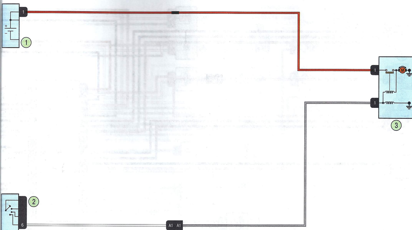
Схема 1. Система пуска двигателя K4M: 1 – аккумуляторная батарея; 2 – выключатель (замок) зажигания; 3 – стартер
