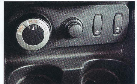
За выбор режимов работы полноприводной трансмиссии отвечает поворотная шайба
