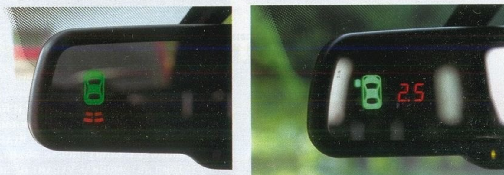
В салонное зеркало встроен индикатор парктроника и давления в шинах
