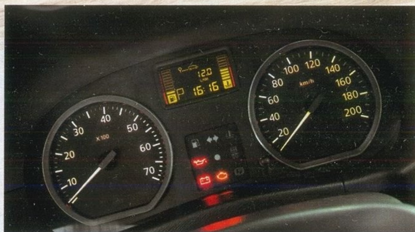
В Ниссане решили оцифровать тахометр в сотнях оборотов, а не в тысячах, как в Renault
