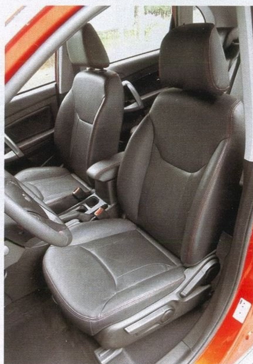
Сиденья с плотной набивкой неплохо распределяют нагрузку. Их высоту легко регулировать при помощи ручки-домкрата
