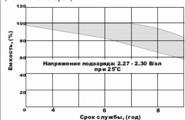
Рис 7.2. Срок службы в буферном режиме работы (10-летние батареи).
